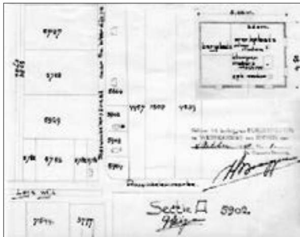
Situatietekening en plattegrond van de machinale klompenmakerij op het perceel A 5902, Roswinkelerstraat 194 te Roswinkel. Geert Hilgen ging gebruik maken van een 3 pk benzinemotor (Gemeentearchief Emmen).
