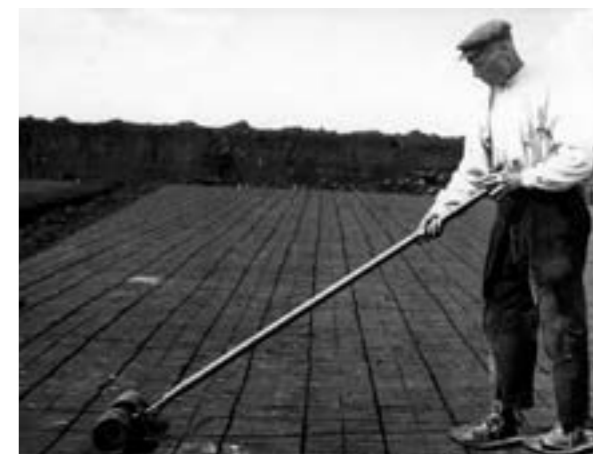
Het apparaat waarmee de baggerturf sneller gesneden kon worden, het 'karrechiesmes' (coll. Roelof Boelens)
