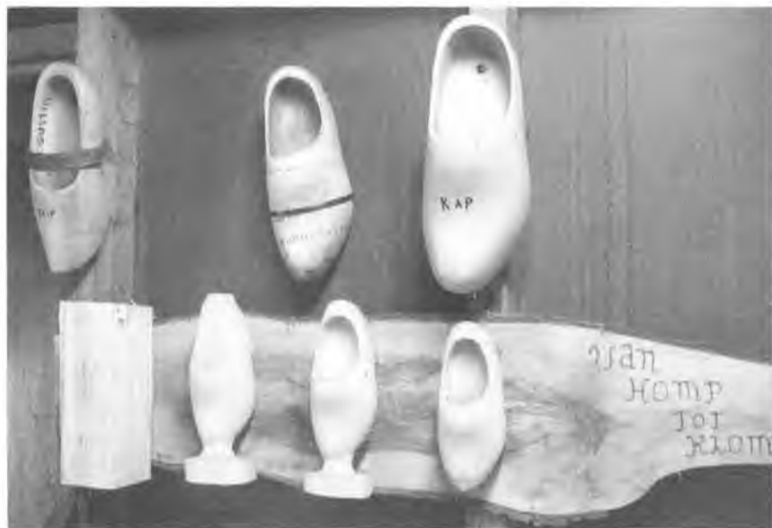
De productiestadia van de klomp als muurdecoratie. Onder het motto 'Van homp tot klomp' worden de fasen van het productieproces in de klompenmakerij van het 'Veenmuseum, de wereld van toen' aan de bezoekers en bezoekers getoond (foto Piet Naber).
